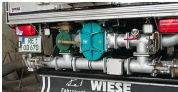
Die Drehkolbenpumpe wird hydraulisch angetrieben. Schaugläser zeigen dem Fahrer den Füllstand. Die Pumpe und die Heckklappe werden über den Bedienkasten gesteuert.
