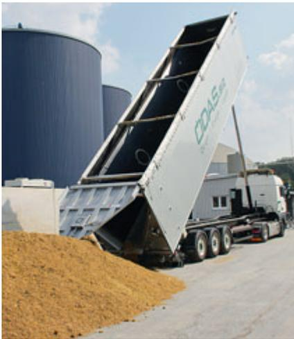
Der Aufbau wird mit einem Zylinder in der Front und 200 l Öl bis auf 48 Grad angekippt. Damit das Material besser rutscht...
