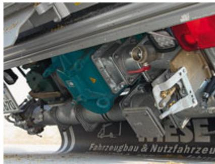
Die gesamte Pumptechnik ist hinter dem Kipp-Drehpunkt der Mulde angebracht.
