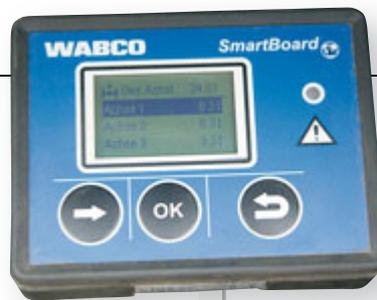
Die Achslasten können über die Wabco Druckuhr komfortabel abgelesen werden. In der Ebene funktioniert das erstaunlich gut.
